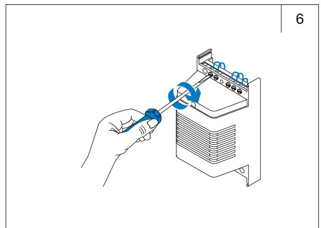
Conexión del repetidor de llamada zumbador.
