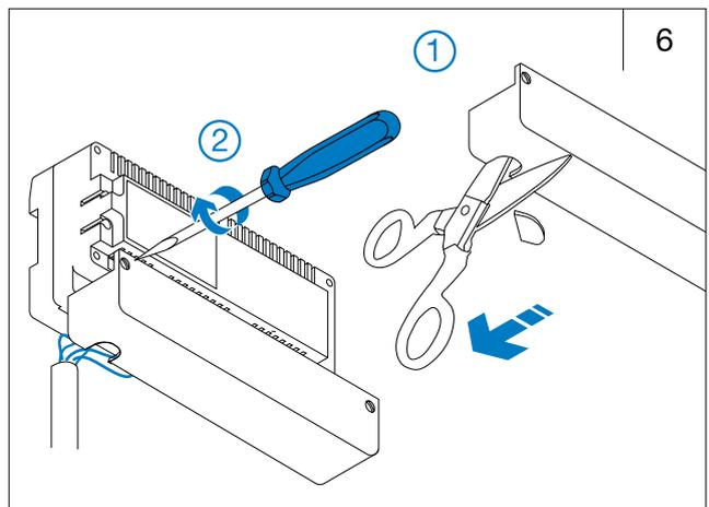
Cierre la tapa de conexiones (1) para permitir el paso de los cables. Cierre (2).
