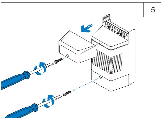
Apertura y fijación del Zumbador 12 v. Ref.: 0E55 58 (Repetición de llamada zumbador). Sólo para sistema convencional.
