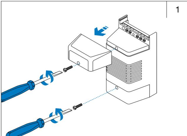
Apertura del EAL-1 Ref.: 0E55 57. (Relé para conexión de elementos visuales o sonoros a 230 Vac.)
