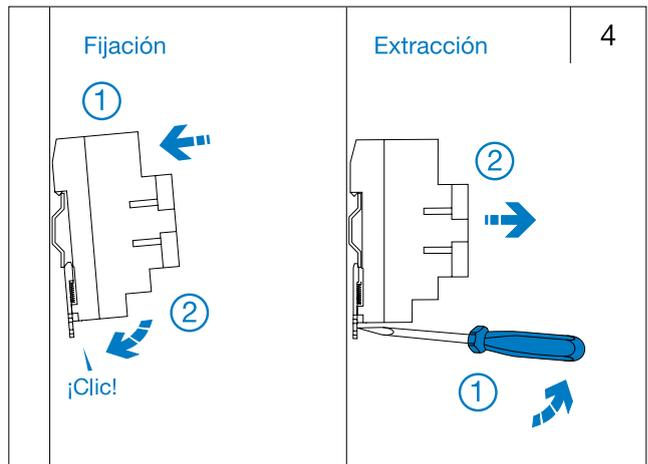
Fijación y extracción sobre carril DIN.
